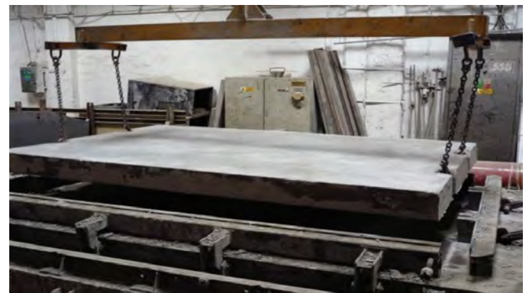
Beton med PUR granulat [Václavík et al., 2012]
